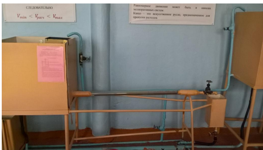
Установка для определения режимов движения жидкости
