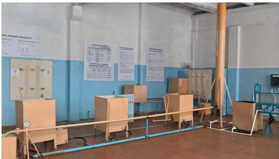
Установка для определения гидравлического удара в напорном трубопроводе
