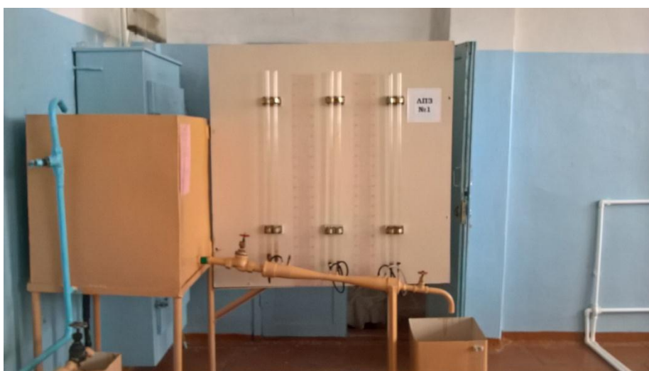
Установка для определения потерь энергии (напора) используя уравнение Бернулли
